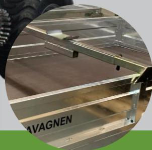
Flaket lyfts enkelt på med hjälp av kranen och en lyftbalk, som centreras på flaket. Inkopplingen sker snabbt via två hydraulslangar. Tippen manövreras med vinschfunktionens fjärrkontroll. Baklämmen är en spridarlucka och flakets sidolämmar är båda fällbara. För att enkelt lasta sand och grus kan du byta ut vagnens grip till en skopa. Flaket blir nästintill outslitligt om du väljer att sätta på en skyddsplåt i aluzink i flakbotten.
